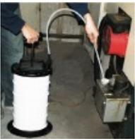
la quantità più piccolo di olio, come per esempio l'asse posteriore, la trasmissione o l'olio motore per motocicli possono essere rimossi con la pompa a vuoto manualmente. Questo richiede che la valvola dell'aria debba venire chiusa e operata con
